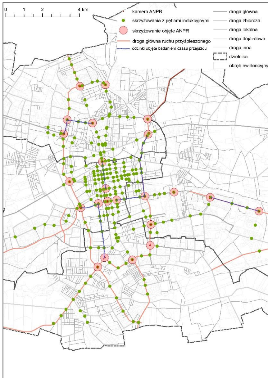
Ryc. 5 Detektory ITS w łódzkiej sieci dróg oraz odcinki dróg wytypowane do pomiarów wykorzystanych w budowie modelu prędkości ruchu
