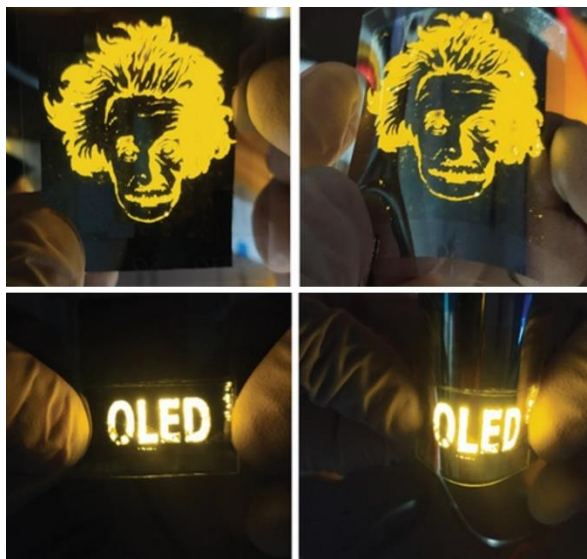
Rys. 40. Elastyczne diody OLED z nadrukiem Einsteina oraz tekstem „OLED” w dwóch różnych pozycjach zginania.
