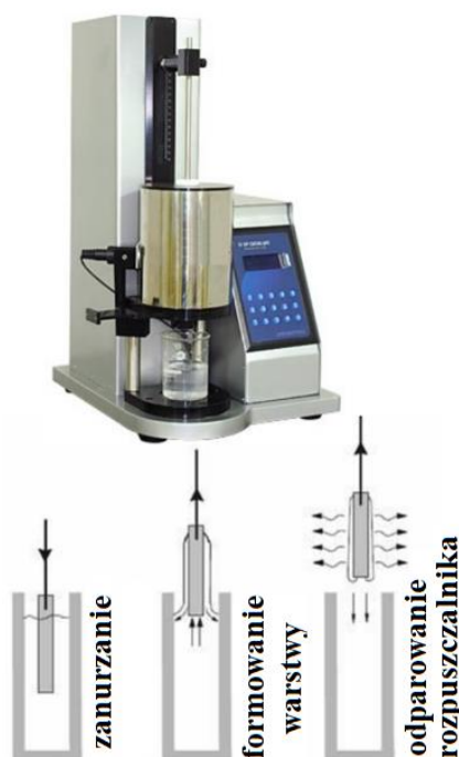
Rys. 45. Urządzenie do tworzenia warstw techniką dip-coating oraz proces tworzenia się warstwy za pomocą techniki dip-coating. 147
