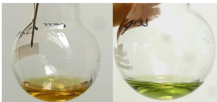
Rys. 49. Fotografia przedstawia rozpuszczony prekursor palladowy Pd(PPh 3 ) 4 w toluenie (po lewo) oraz układ katalityczny utworzony przez prekursor palladowy Pd(PPh 3 ) 4 oraz ligand 3a w toluenie (po prawo).
