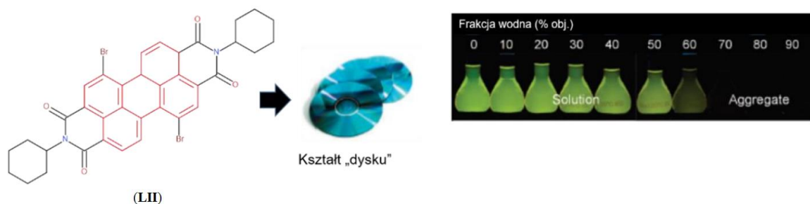
Rys. 32. Zjawisko wygaszania spowodowane agregacją cząsteczek na przykładzie związku DDPD.
